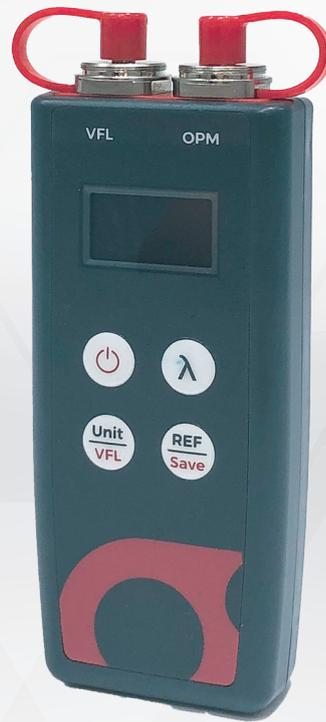
Ascentac OPM110 系列為光功率計，可進行寬動態範圍且高精度光功率量測，提供動態範圍 +6 至 -70dBm 或 +26 至 -50dBm，靈敏度高、線性好、測試速度快，操作簡易，內建可見光源故障定位器 (VFL)。
