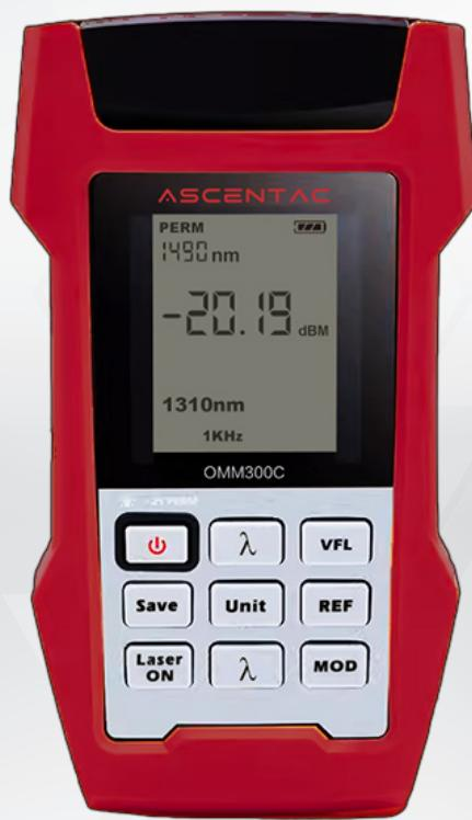
Ascentac OMM300C 系列因應工程應用需求，使用配套的光源與光功率計，具備自動波長識別功能，可儲存高達一千筆測試數據，並透過 USB 傳輸至電腦製作測試報告。該系列採三顆三號乾電池供電，充電電池亦相容，可透過 Mini USB 充電。
